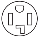
Tomacorriente de 4 hilos (14-30R)
