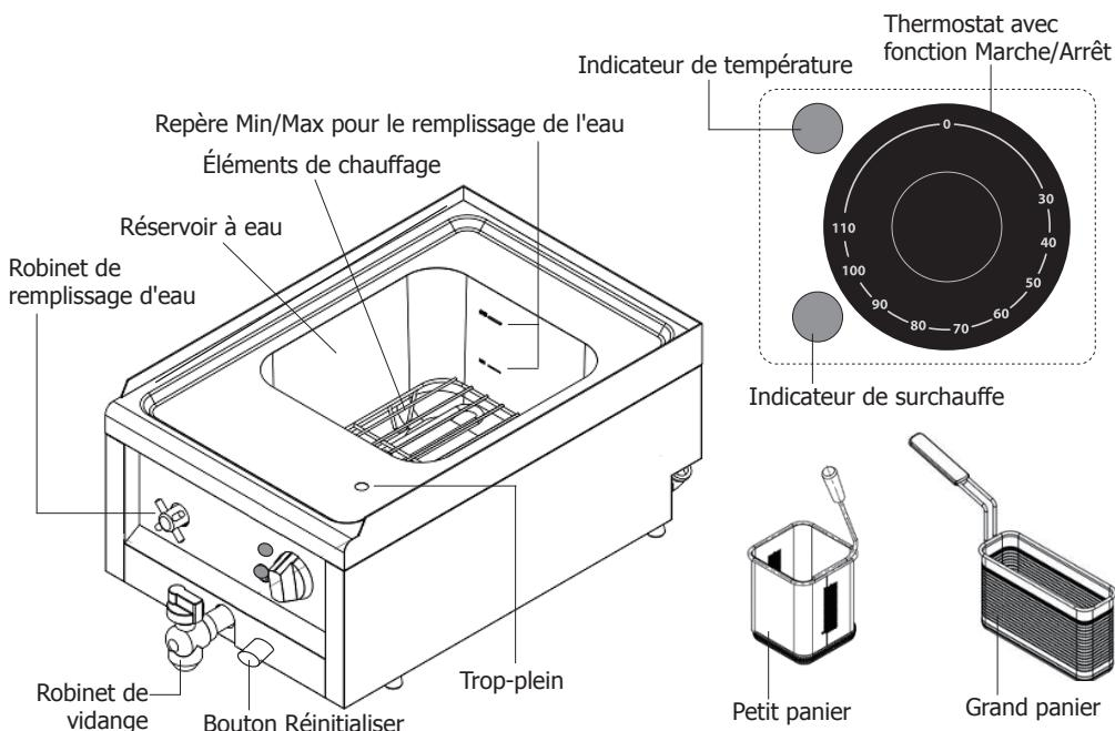
**Remarque : Avant d'utiliser l'appareil pour la première fois, nettoyez soigneusement toutes les pièces. Laissez-le sécher complètement.**
